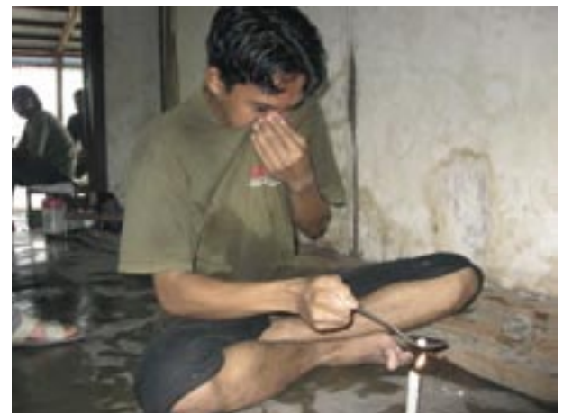
Séparation artisanale de l'amalgame mercure-or par brûlage, dans l'île de Célèbes (« Sulawesi » en indonésien). Les orpailleurs et leur famille s'intoxiquent par inhalation des vapeurs de mercure.
