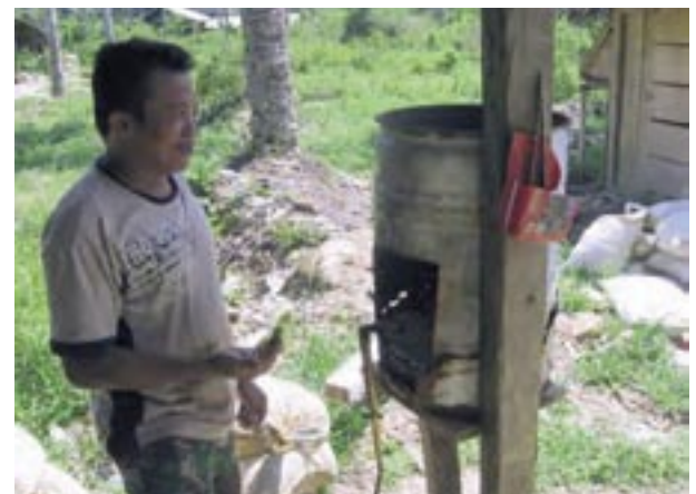
Séparation artisanale de l'amalgame mercure-or par brûlage, dans l'île de Célèbes (« Sulawesi » en indonésien). Les orpailleurs et leur famille s'intoxiquent par inhalation des vapeurs de mercure.
